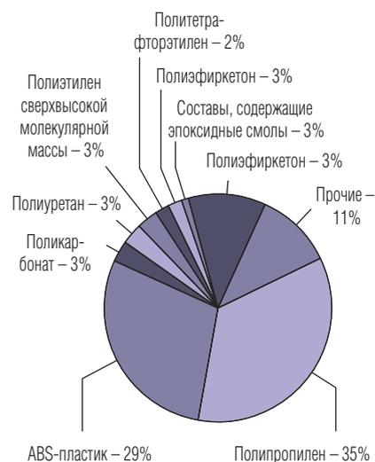
**Рис. 3.** Применение различных полимеров в бытовой технике
